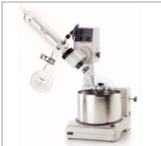
Fig. 1.7. Rotoevaporador
